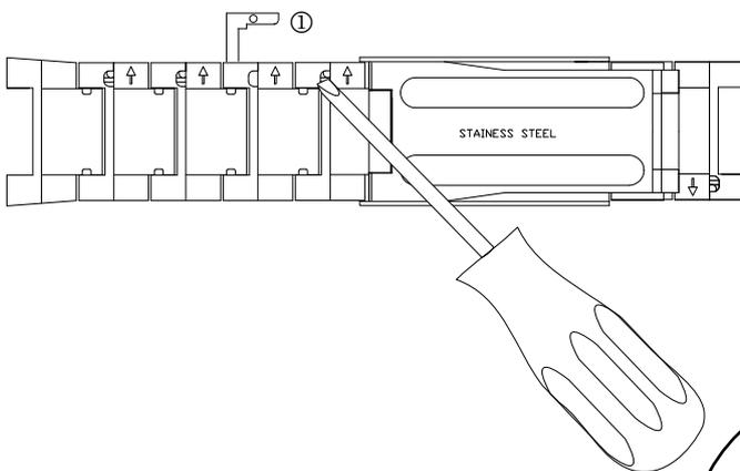
Zum Kürzen von Armbändern mit "L" förmigen Stiften ①, legen Sie das Band so, dass der Stift in Pfeilrichtung mit dem Bandkürzwerkzeug oder einem kleinen Schraubendreher herausgeschoben werden kann.
