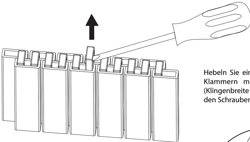
Hebeln Sie eine der im Flexarmband eingesetzten Klammern mit einem kleinen Schraubendreher (Klingenbreite ca. 1,4mm) heraus, dazu schieben Sie den Schraubendreher unter die Klammer.
