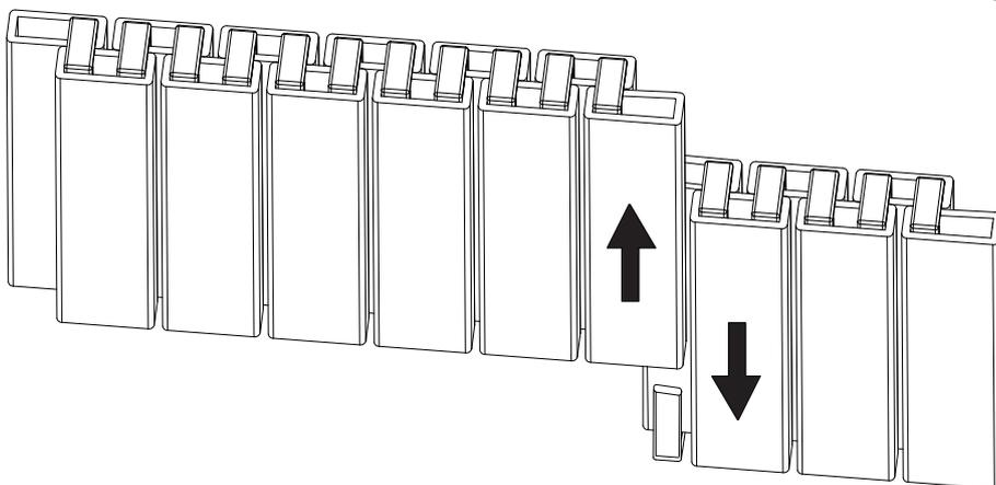
Das Flexarmband kann nun wie auf dem Bild dargestellt getrennt werden. Entnehmen Sie nun auf diese Weise die gewünschte Menge an Bandgliedern, danach setzen Sie das Band in umgekehrter Reihenfolge wieder zusammen. Achten Sie darauf, dass die Klammern beim Zusammenpressen einrasten.
