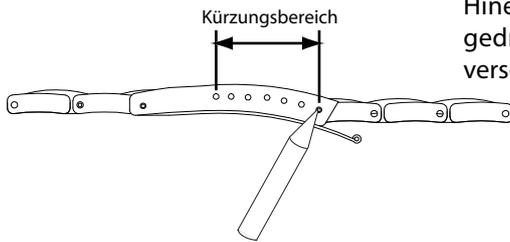
In der Schließe wird das Band durch einen Federsteg gehalten, dieser kann durch Hineindrücken mit einem spitzen Gegenstand zusammengedrückt werden. In gedrückter Stellung nun das Band in Richtung der gewünschten Einstellung verschieben. Öffnen Sie hierzu gegebenenfalls die Schließe.
