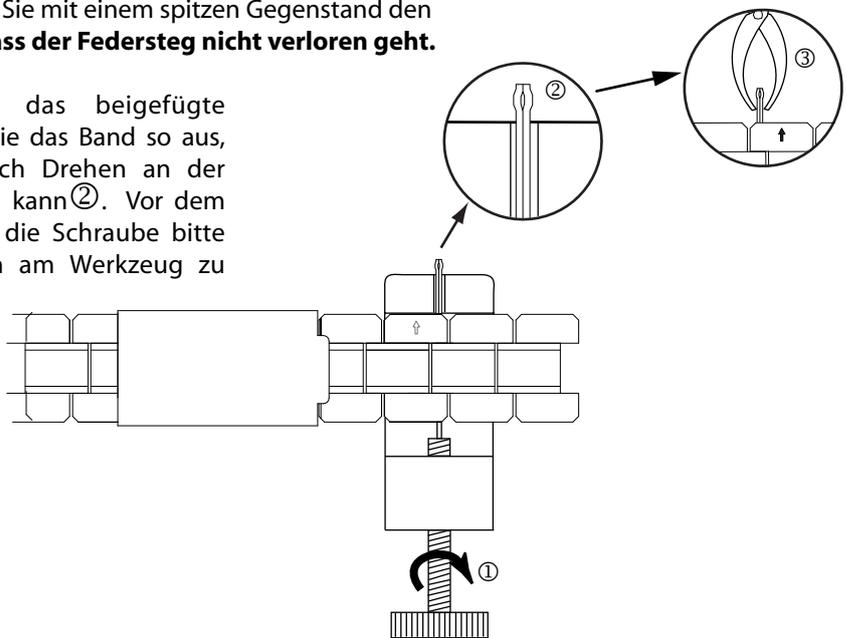
Um das gekürzte Band wieder zusammenzusetzen, den Stift nun entgegen der Pfeilrichtung wieder einsetzen und hineindrücken bis er einrastet.
